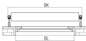
Guide oltre luce fissate frontalmente con distanziali Rail guides with frontal installation through telescopic holders
