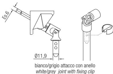
**Attacco asta tramite anello di giunzione**
